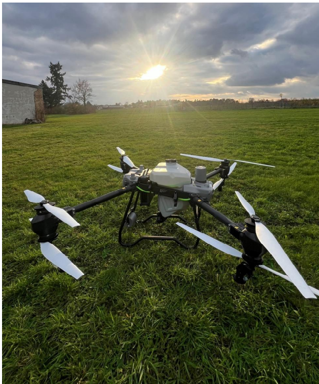
Abbildung 1: Agrardrohne mit Rotationszerstäubern. Quelle: Dienstleistungszentrum Ländlicher Raum Mosel
