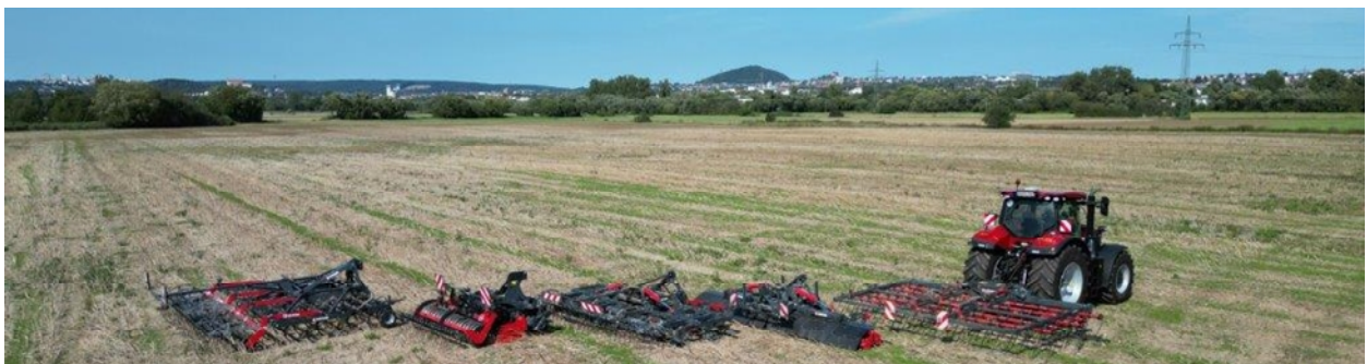
Abbildung 1: Demonstrationsfläche mit einem Teil der getesteten Geräte zur ultraflachen Bodenbearbeitung. Quelle: Schneider, LLH
