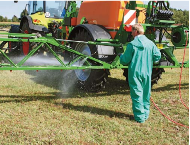
Reinigung des Pflanzenschutzgerätes auf dem Feld
