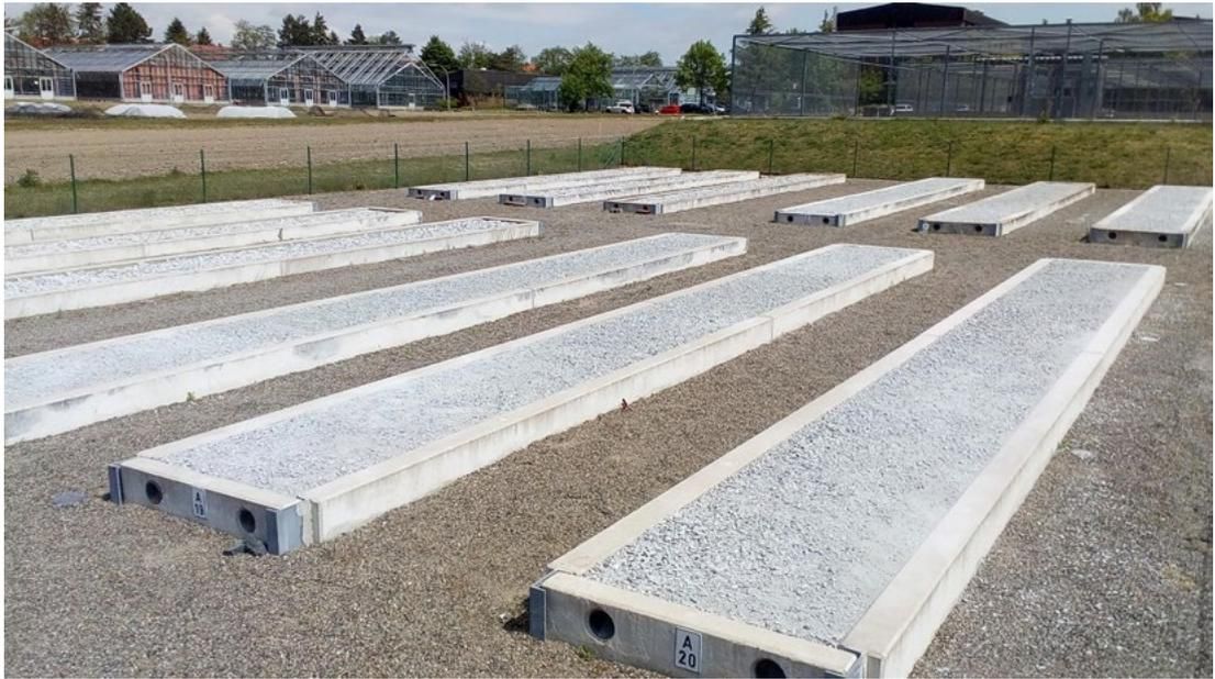
Abbildung 1: Modell-Versuchsfläche zum Vegetationsmanagement auf bzw. an Gleisanlagen im JKI Braunschweig (Schotter- und Kiesflächen), Quelle: JKI.
