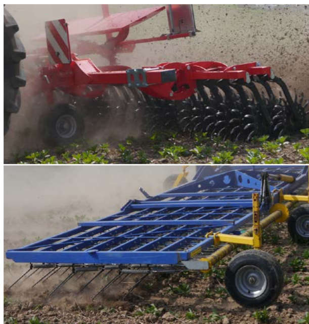
Abb. 8: Roll bzw. Sternhacke „Rotary Hoe“ (o.) und Federstriegel (u.) (M. Männel)
