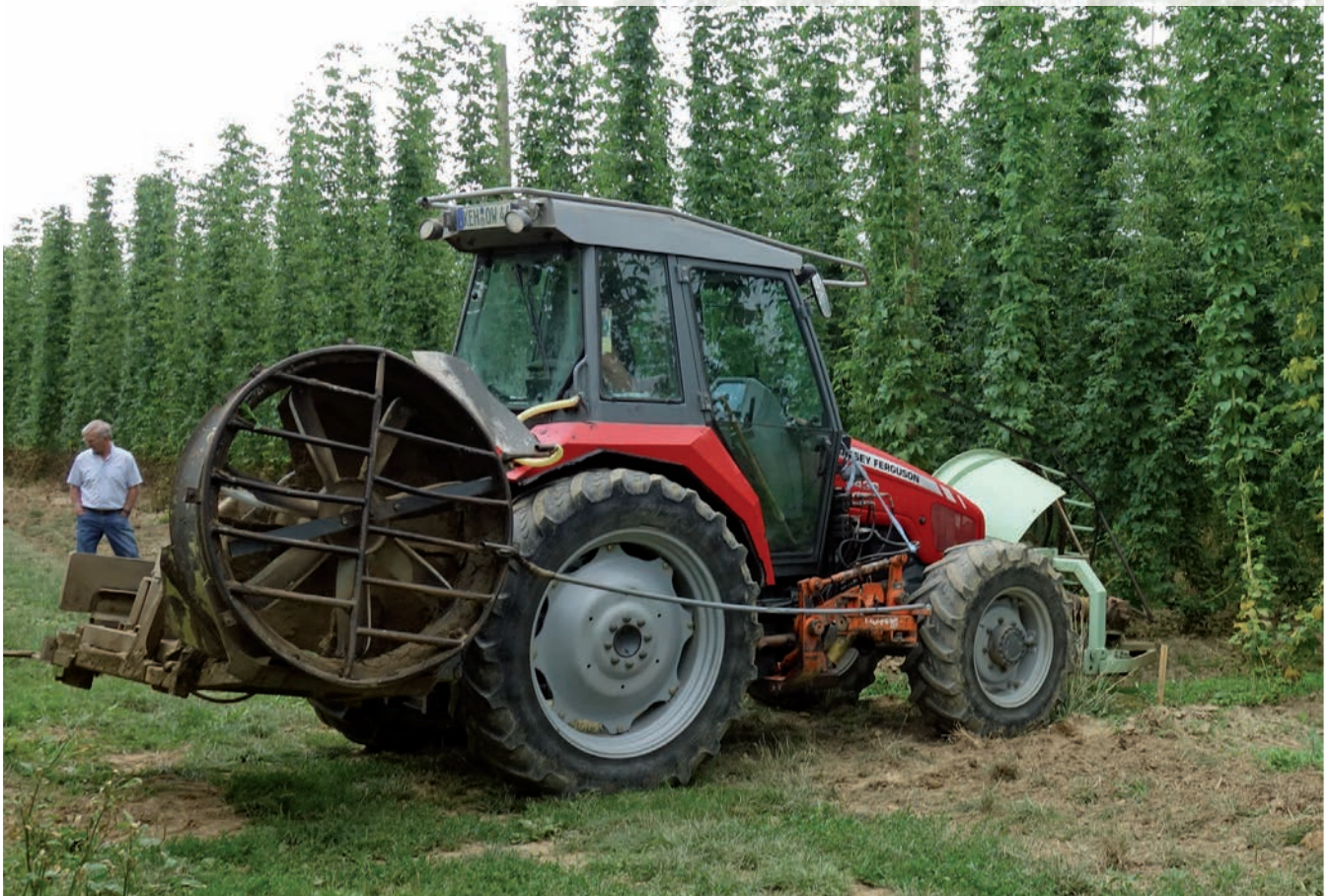
Mechanisches Hopfenputzen mit einem Laubsauger
