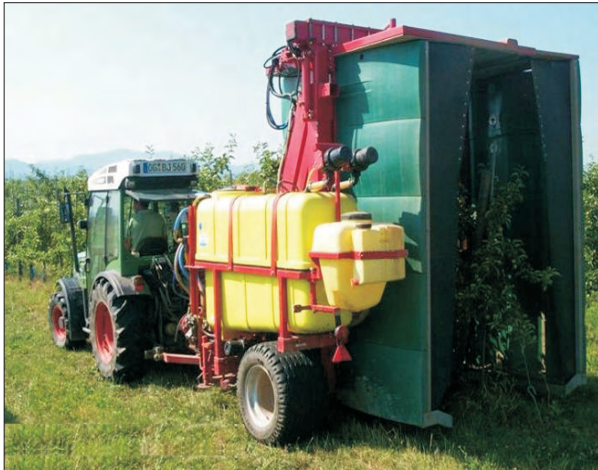
Tunnelspritzgerät im Obstbau zur Abdriftreduktion
