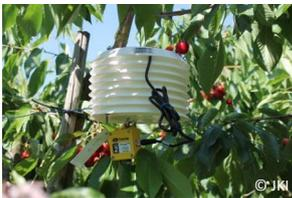
Abbildung: Temperatur und relative Luftfeuchtigkeit werden mit Datenloggern erfasst
